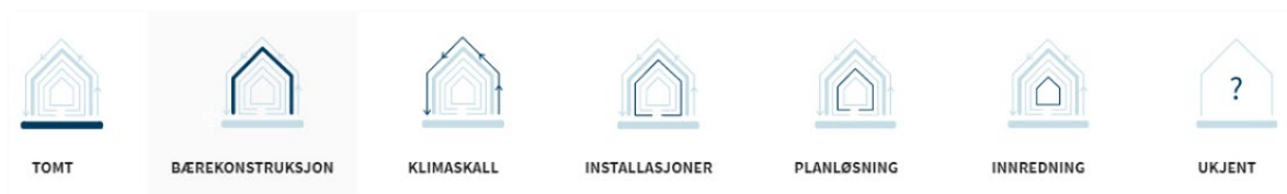
Bilde 14: Bygningslag iht. Shearing Layers of Brand
